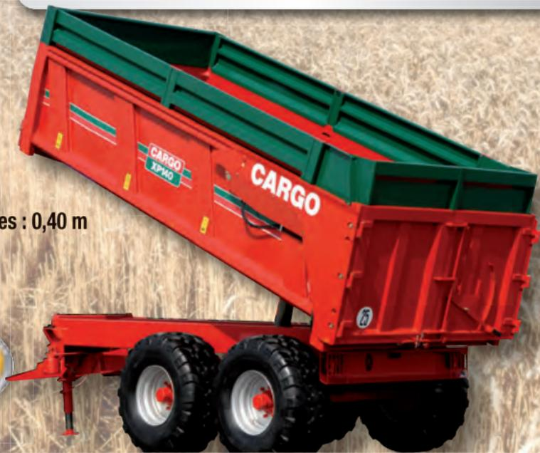
Photo XP140 avec option roues 560x60 R 22,5 et porte hydraulique
